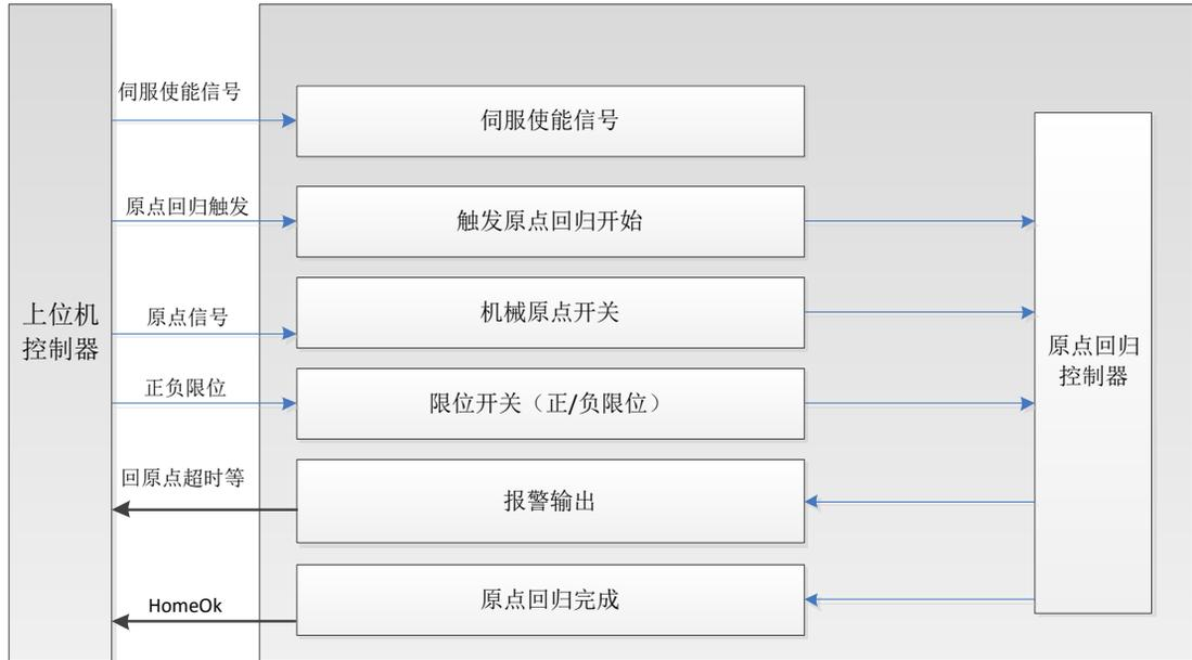
原点回归模式是用来找寻机械原点，电机 Z 信号，或者指定固定位置为原点，用来设定运行的初始位置。
